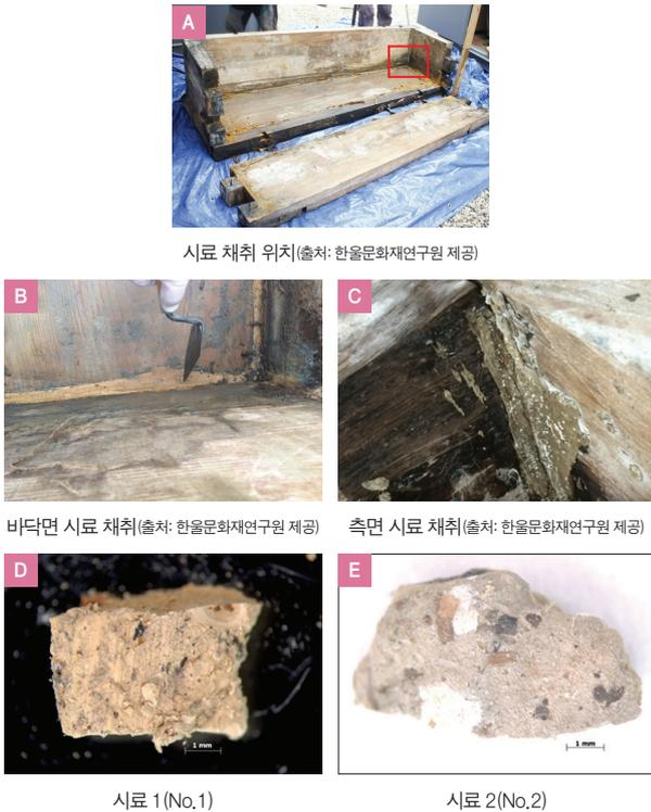
그림 4 유기물 시료 채취 위치 및 시료 모습
